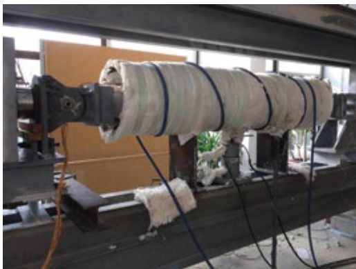
Laboratorijska jedinica za ispitivanje nosivih elemenata pri djelovanju visokih temperatura
